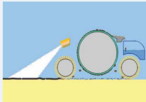
Zwei gegenläufige Zylinderbürsten sorgen für Sauberkeit. Das Rotowash-Prinzip der beiden gegenläufigen Zylinderbürsten mit der mittigen Trommel erlaubt eine extrem gründliche und ressourcenschonende Reinigung. Im Vergleich zu herkömmlichen Reinigungsmethoden ermöglicht das Einsparungen an Wasser und Chemie von bis zu 80%!
